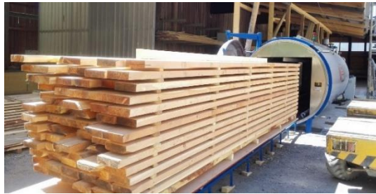
Planches entrant dans un séchoir sous vide Planches introduites dans un séchoir à air chaud climatisé
