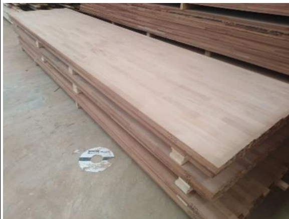
Panneaux bois lamellé collé Bois massif reconstitué (carrelet) @AT3 PGDF
