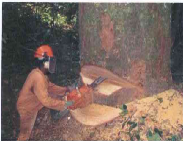
Image 2 : Abattage contrôlé : sécurité des travailleurs, valorisation optimale de la ressource, limitation de l'impact sur le peuplement résiduel (source : JG Jourget)
