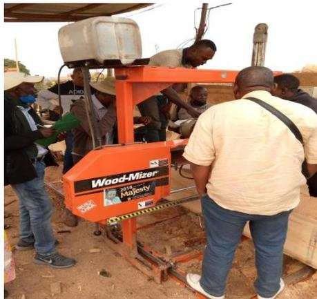
**Figure 6. Type de machines installées pour le sciage des bois dans les ports de Kinkole**
