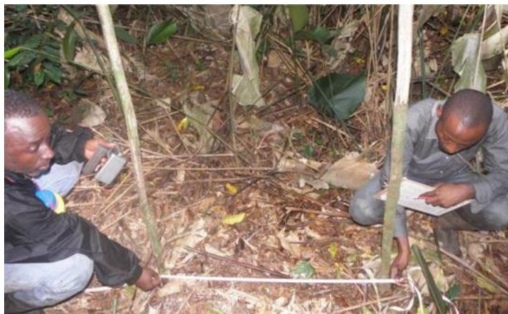
Figure 3 : Remplissage d'une fiche de layonnage lors d'une vérification de chainage
