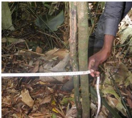
**Photo 2 : Mesure d'un écart de longueur en fin de placette entre le jalon posé par l'équipe de vérification et celui de l'équipe de layonnage de l'entreprise**
