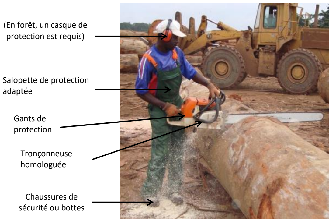
Figure 10 : Equipement minimum pour l'opérateur (étêtage et tronçonnage)
