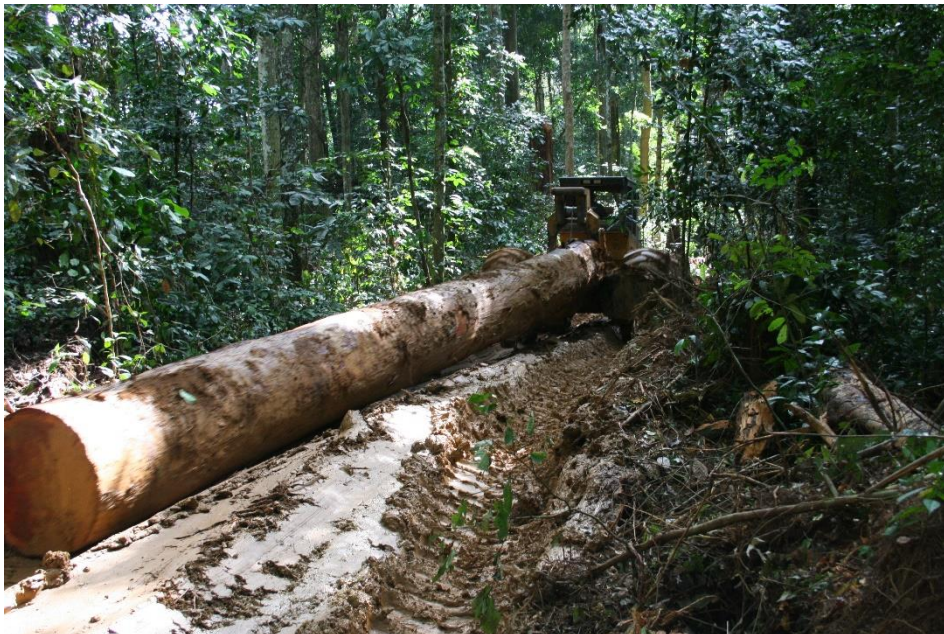
Photo 2 : Skidder débardant une grume
