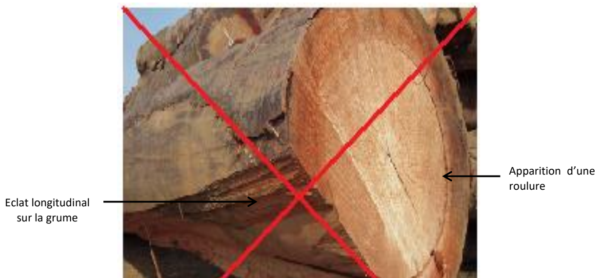
Figure 9 : Résultat d'un mauvais étêtage
