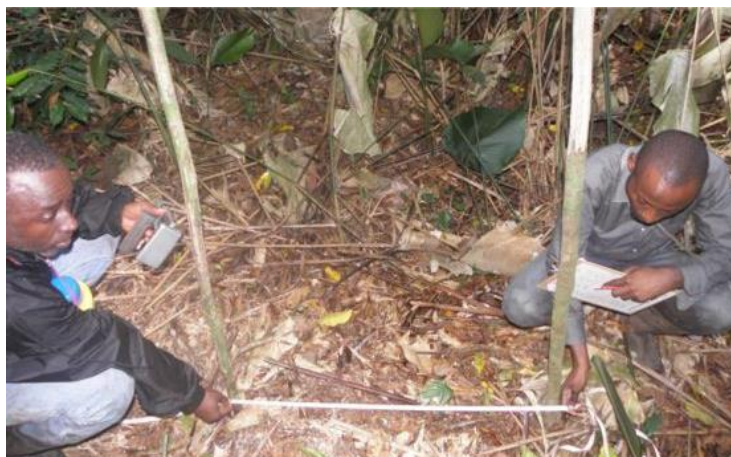
Photo 2 : Mesure d'un écart de longueur en fin de placette entre le jalon posé par l'équipe de vérification et celui de l'équipe de layonnage de l'entreprise
